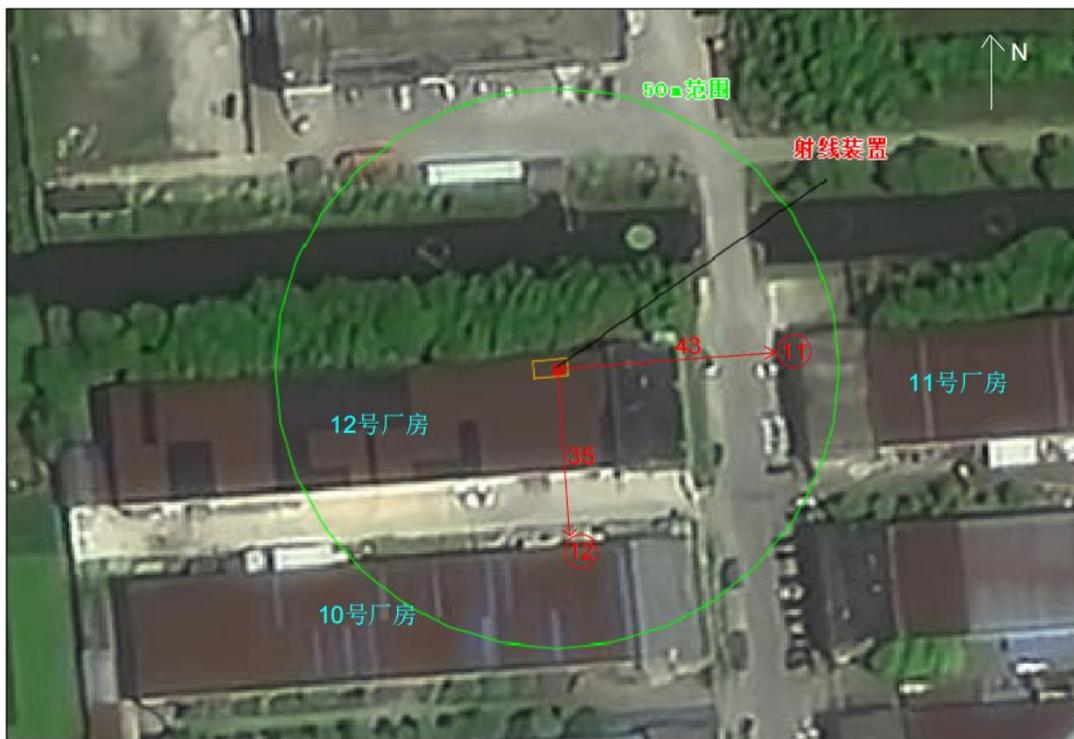
图 11-3 本项目工业用 X 射线探伤装置周围计算点位分布示意图
