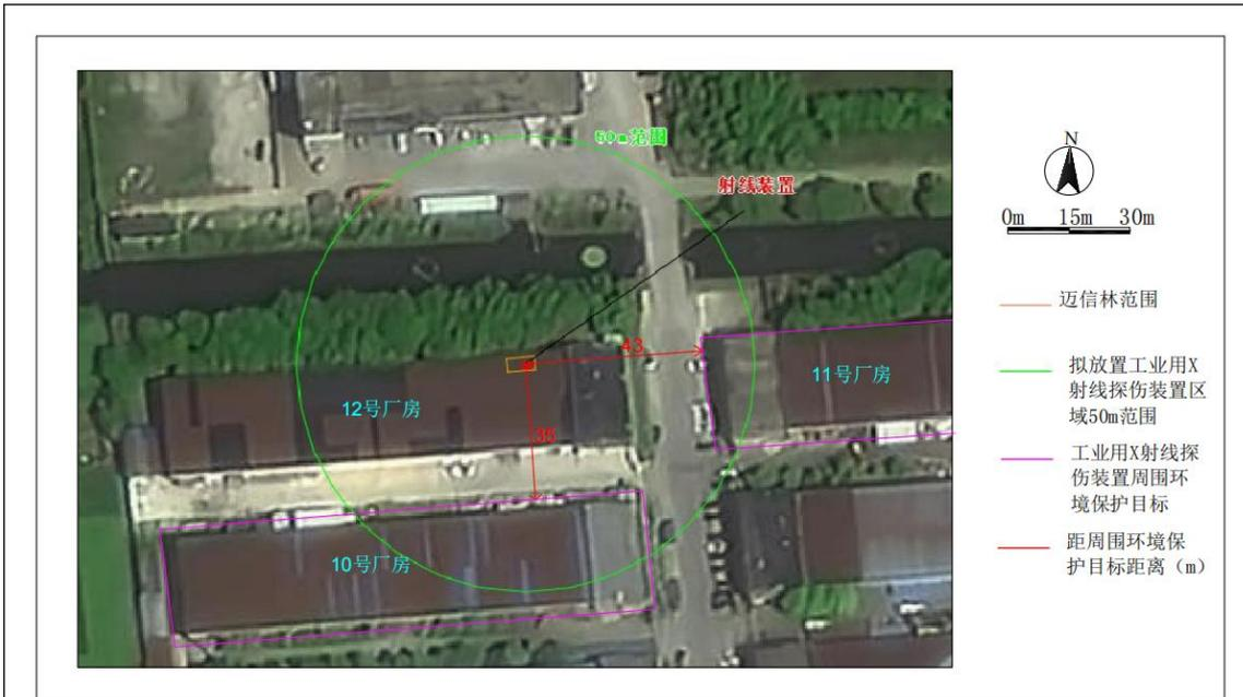
图7-2 X射线装置周边环境目标平面布置图
