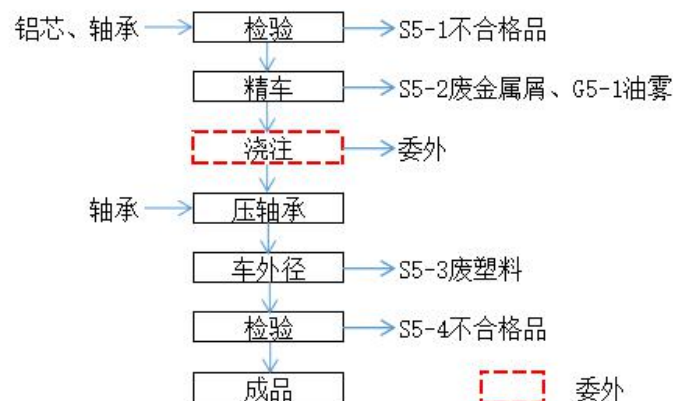
图 5-5 铝芯轮生产工艺流程图
