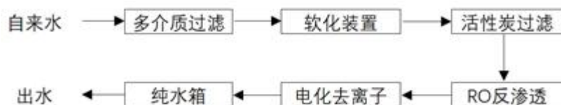
图 4-2 纯水制备工艺流程
